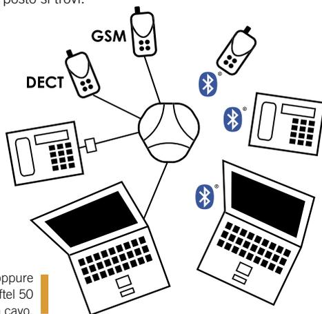
Il Konftel 60W prevede il collegamento via cavo oppure senza fili con tecnologia Bluetooth. Il Konftel 50 prevede il collegamento via cavo.
